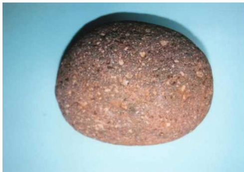
大神島南東部海岸の潮間帯から採集。石英、長石、チャートの細粒子が鉄分でかためられた礫岩 (1976. 8)
